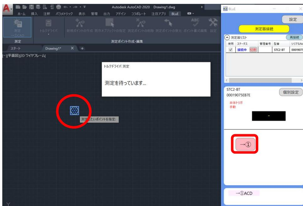
(3) 測定器本体の操作（締める→緩める）を行うことにより測定画面(BLuE)に測定値が表示されます。
