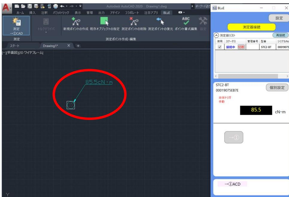
※測定画面(BLuE)で接続している測定器と AutoCAD 上の測定ポイント種別が、同じでないと測定値を反映することができません。
