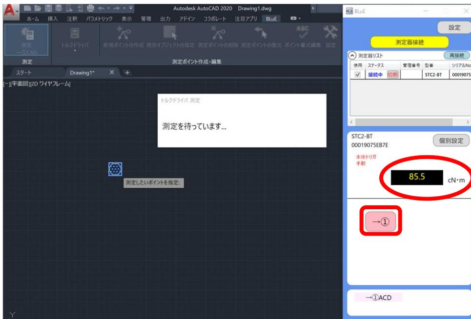
(4) 測定画面の測定ボタン（→①）を押下すると、ピックした測定ポイントに対して測定値が反映されます。
