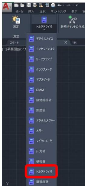
(2) リボンメニューの「新規ポイントの作成」を押下し、図面上の任意の箇所をピックすると測定ポイントが作成されます。
